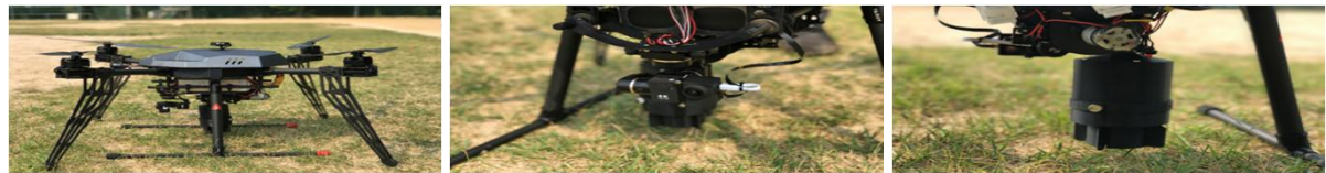
【드론을 이용한 연안 퇴적물 시료 채취장치 시제품】
